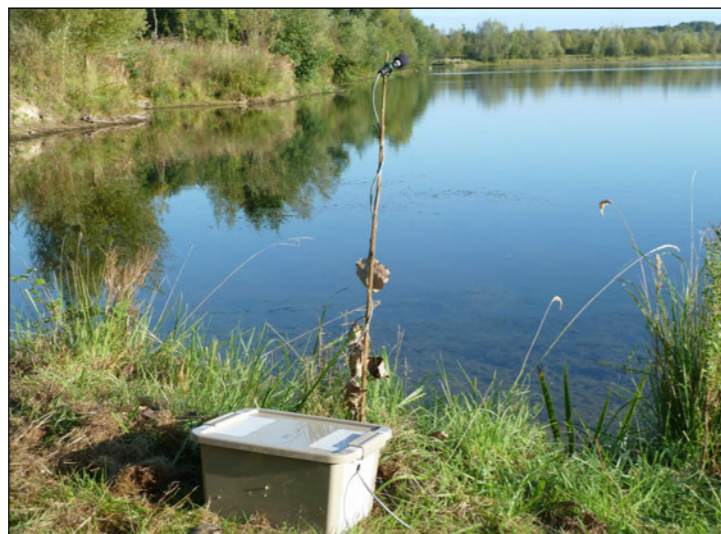
Photo 4 : Enregistreur automatique SM2 BAT
